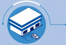
Estructuras con estacionamientos exteriores a la edificación, eliminando la posibilidad de piso débil en la estructura.
